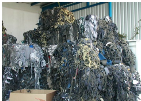
Slika 1: Stisnjen in povezan odpad tekstilnih kompozitov
